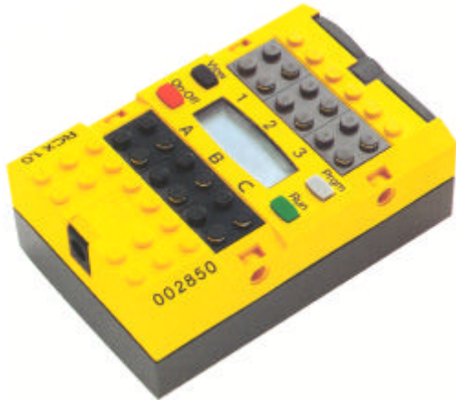
Abb. 1: Der RCX Baustein, Herzstück der Mindstorms Roboter
